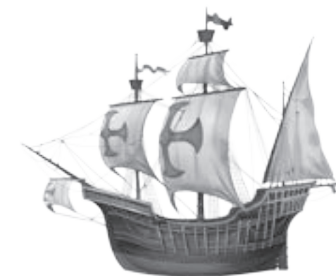
▲ La caravelle mesure de 15 à 20 m de longueur et compte de 1 à 3 mâts.
